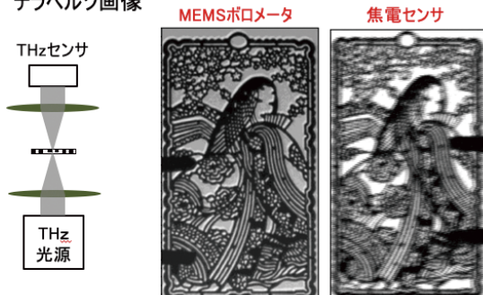
(b) MEMSボロメータ(左)と焦電センサ(右)で取得したテラヘルツ画像
