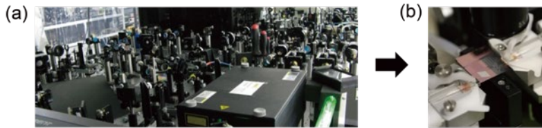
図1 (a)従来の光量子情報処理装置と、その(b)チップ集積化のイメージ
