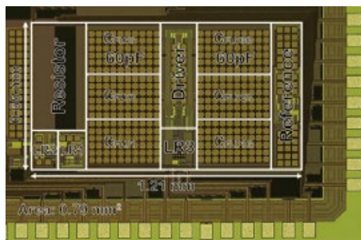
図3 小型ハーベスタの利用を前提とした環境発電利用システムの例。ナノワットオーダーの超低消費電力で動作するフルオンチップ昇圧コンバータ。
