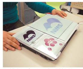
図3 有機/金属ハイブリッドポリマーを用いた固体表示デバイス
