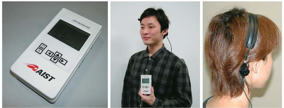
図2 試作された骨導超音波補聴器。音声で振幅変調された超音波が骨導呈示される。フルデジタル方式による柔軟かつ高度な信号処理機能と、胸ポケットに収まる程度の実用的な小型化を実現している。
