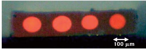
図2 筐体内インターコネクションのための ポリマー並列光導波路 (PPOW) の断面写真
